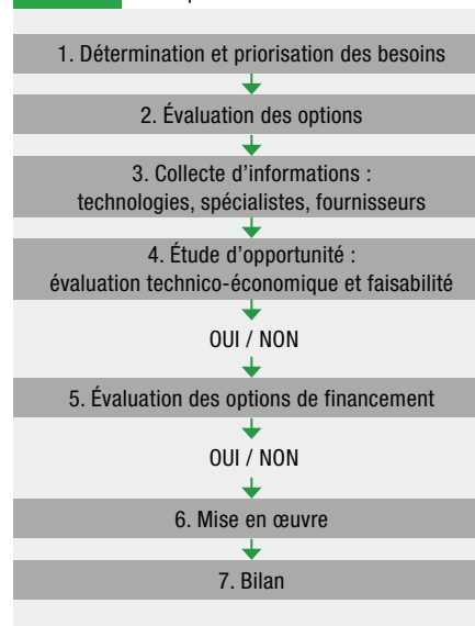
Figure 1 Démarche pour l'adoption de techniques électriques efficaces
