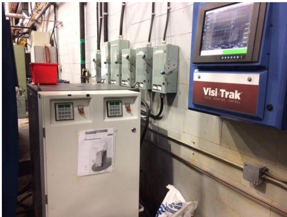
Figure 7. Chauffe moule et système de pilotage en temps réel (à droite)
