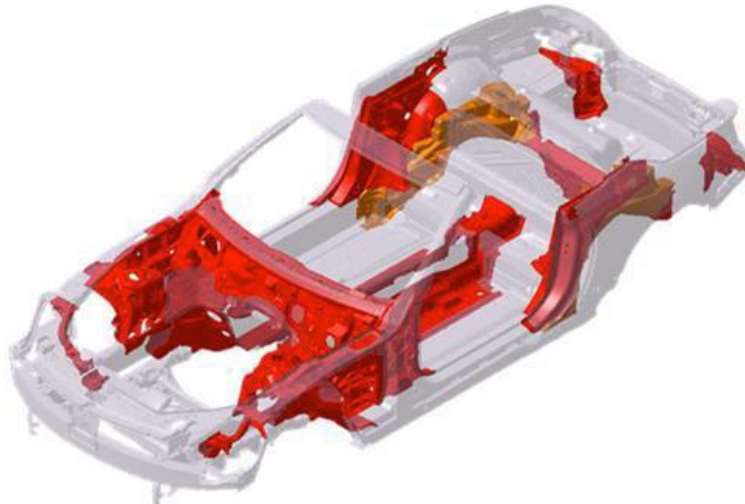
Figure 11. Potentiel de pièces structurales moulées sous pression sous vide (Mercedes SL) Source: Daimler AG, Dr. Lutz Storsberg, Mercedes-Benz Cars, Structural Symposium Bühler AG, Hamilton, Canada, October 1, 2013
