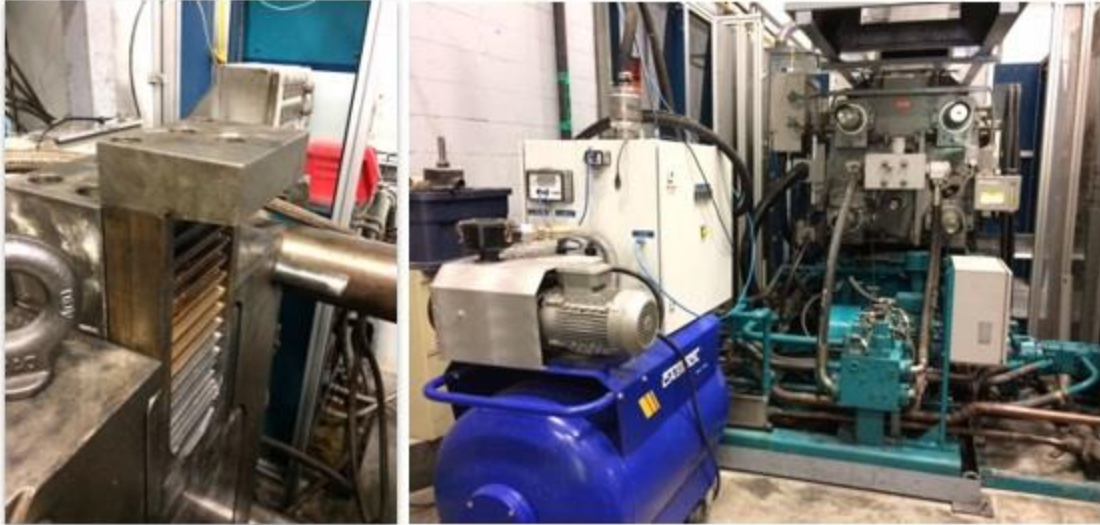
Figure 10. Tirage d'air massif monté sur un moule et pompe à vide avec réservoir pour le moulage sous pression sous vide
