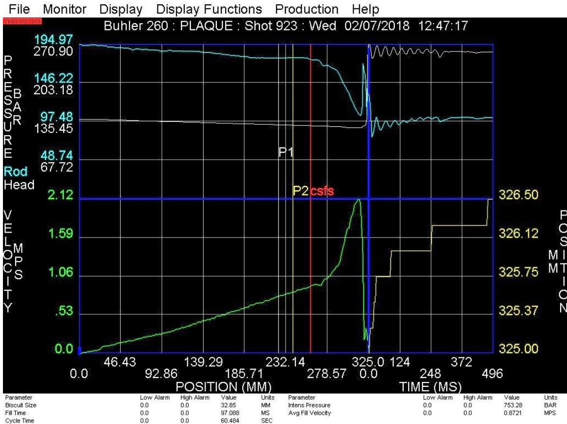
Figure 9. Cycle du moulage sous pression enregistré par un système d'acquisition de données
