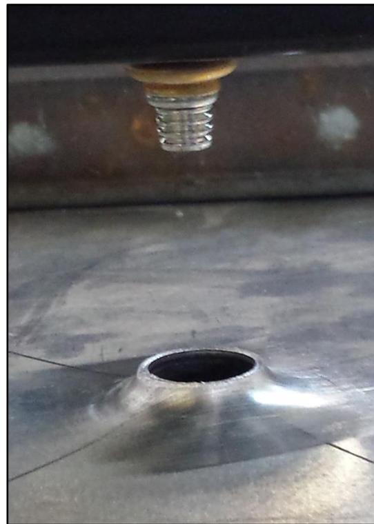
Figure 6 – Défaillance sur l'appui axial de la membrure
