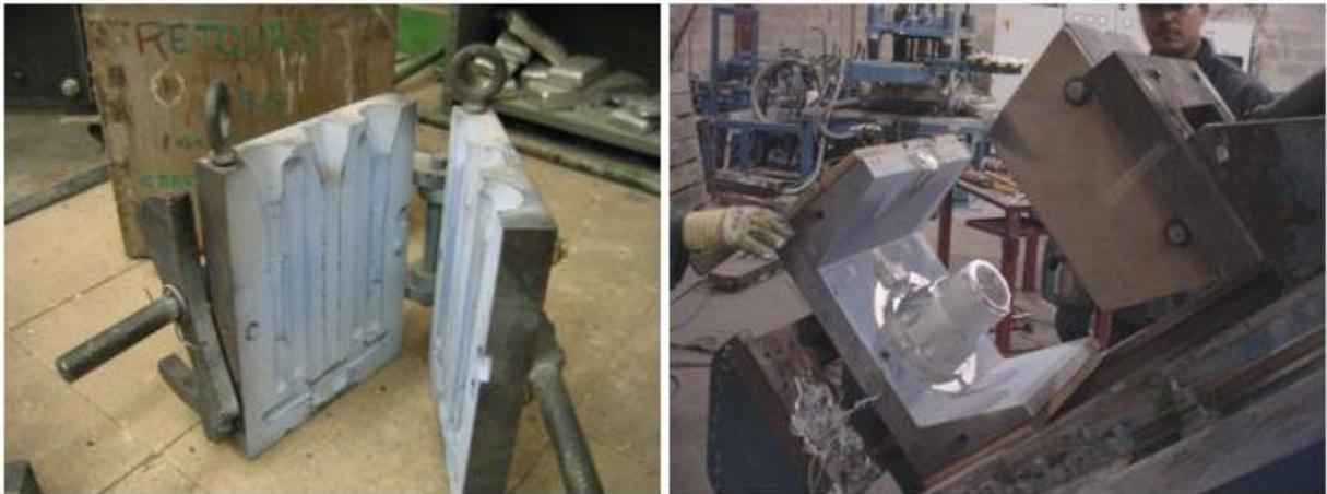
**Figure 3.** Moule permanent gravité monté sur charnières pour le moulage de barreaux de traction coulés à part (gauche); moule permanent gravité basculé (droite)
