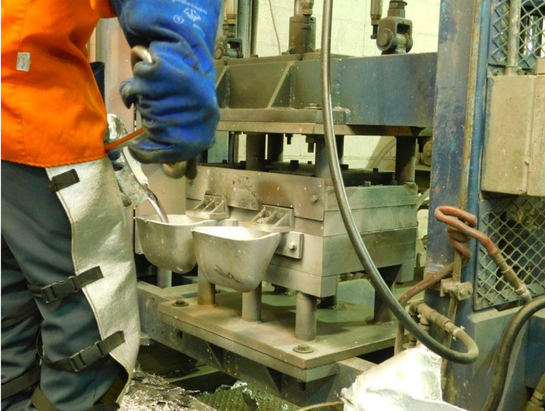
Figure 4. Moulage par basculement (photo Paber Aluminium)
