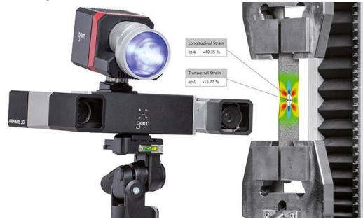
Figure 6 : Exemple de système de corrélation d'images 3D [6].
