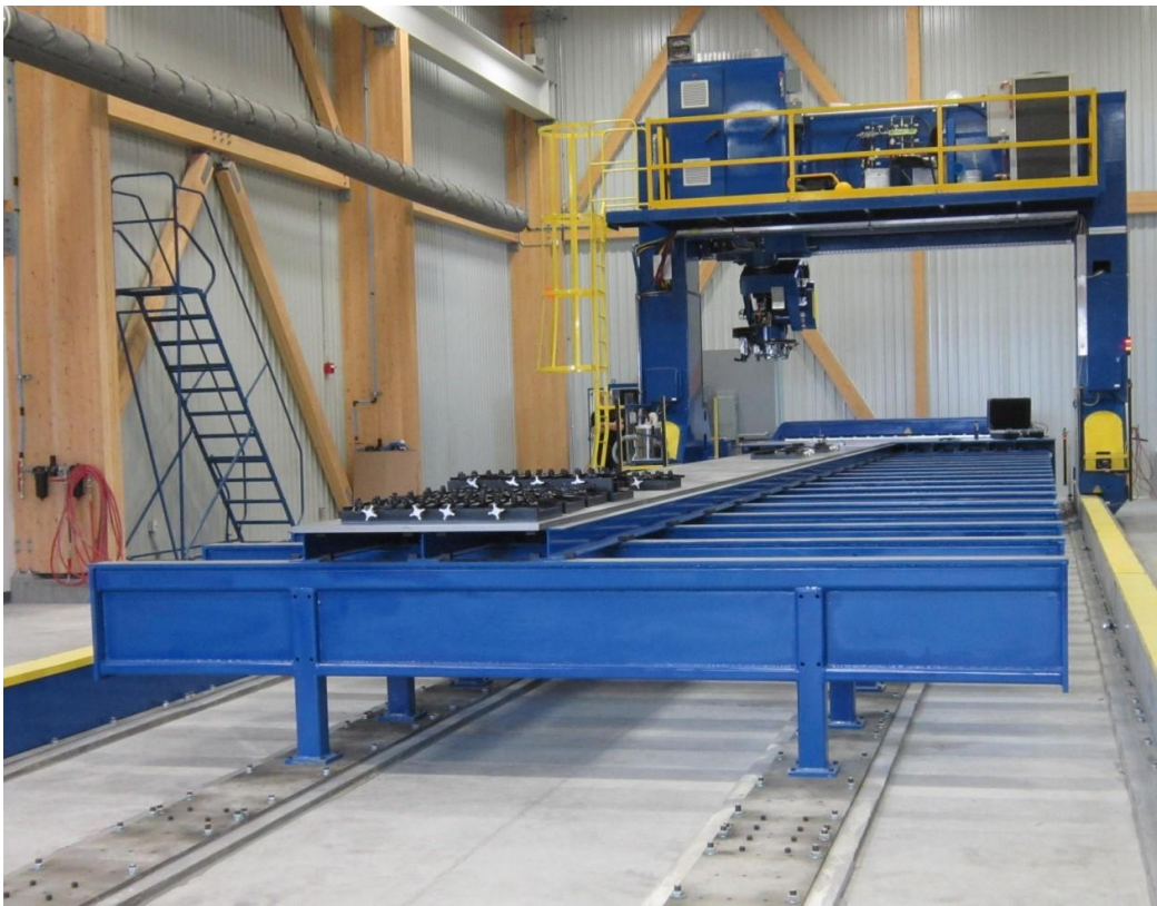
Figure 6. Équipement de soudage conçu pour le FSW [voir 12 pour informations]
