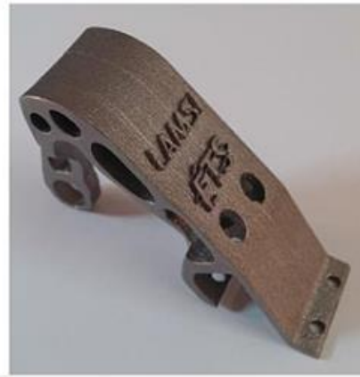
Figure 10 Charnières des portes du train d'atterrissage [19] .
