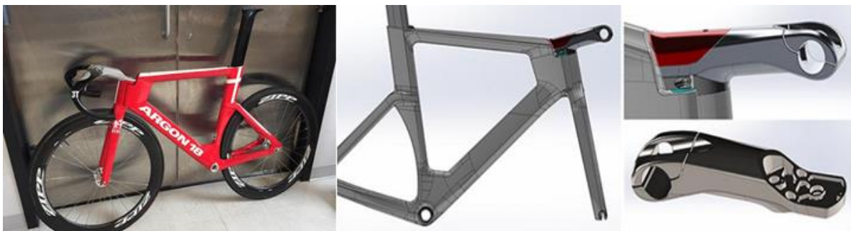
Figure 12. Vélo olympique dont la potence est fabriquée par SLM (Selective Laser Melting) [20].
