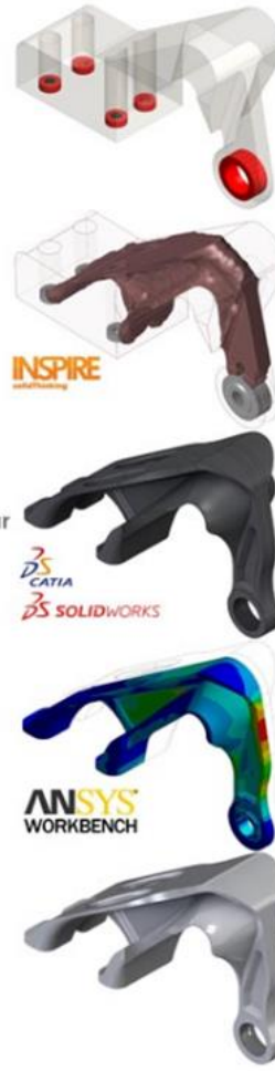
Figure 11 Séquence d'optimisation typique d'une pièce [19].
