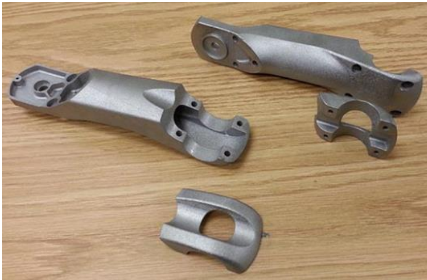
Figure 13. Potence d'un vélo olympique réalisé par (FA) [20] .
