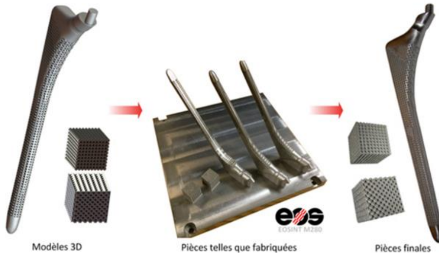
Figure 15. Processus de fabrication des tiges fémorale [22].
