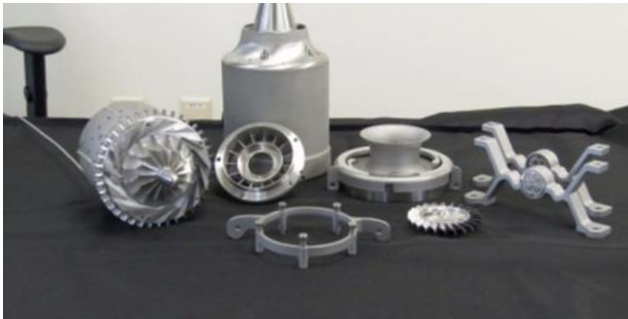
Figure 14. Turboréacteur fabriqué par DLMM (Direct Laser Metal Melting) [21] .
