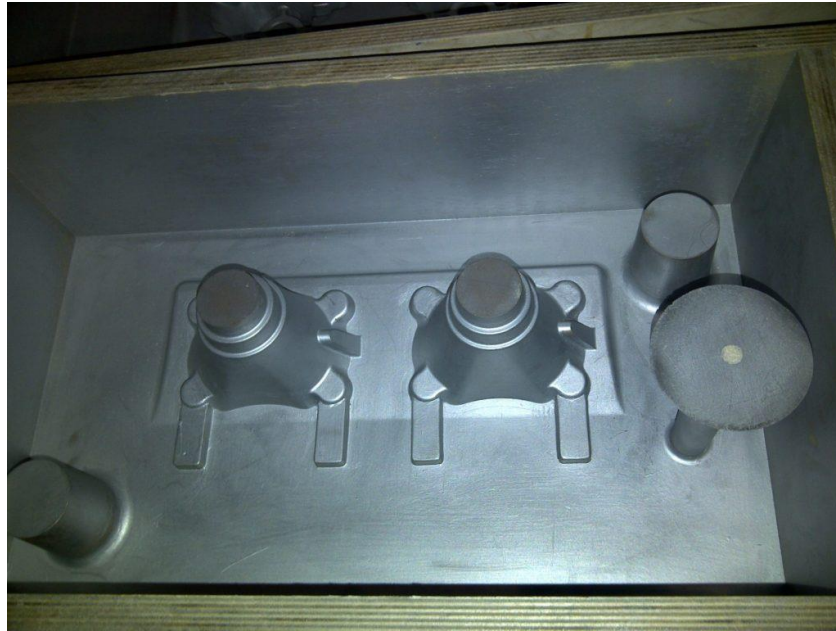
Figure 7. Outillage de type caisson pour moule au sable à prise chimique avec descente de coulée en place; châssis supérieur
