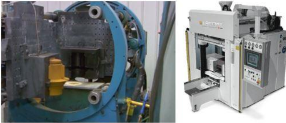
Figure 9. Procédé de noyautage à chambre chaude à gauche et à chambre froide à droite (robertsinfo.com).
