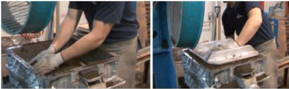
Figure 5a. Compression du sable contre la plaque modèle du châssis inférieur, terminé par des secousses ( jolt )
