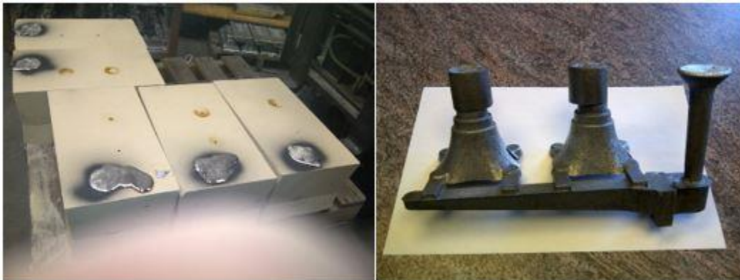
Figure 3. Moules coulés; trous d'évents visibles et moulage final avec masselottes en charge
