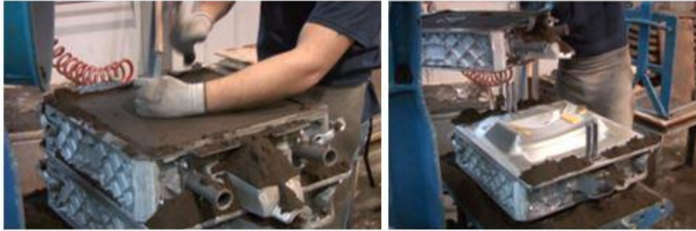
Figure 5c. Percement des événements dans le châssis supérieur, soulèvement du châssis supérieur pour extraire la plaque modèle
