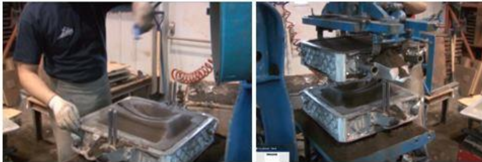
Figure 5d. Nettoyage et inspection de l'empreinte, fermeture du moule
