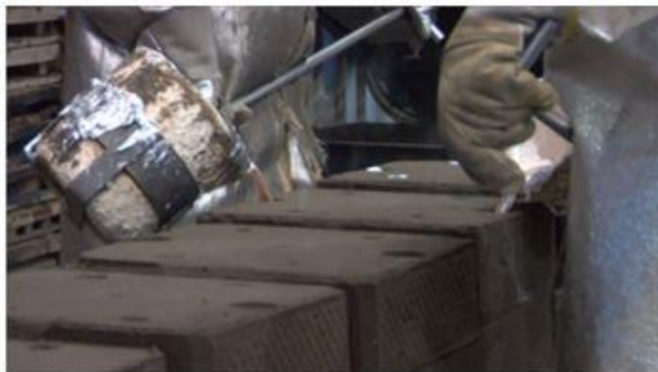
Figure 4. Coulée de moules en sable à vert
