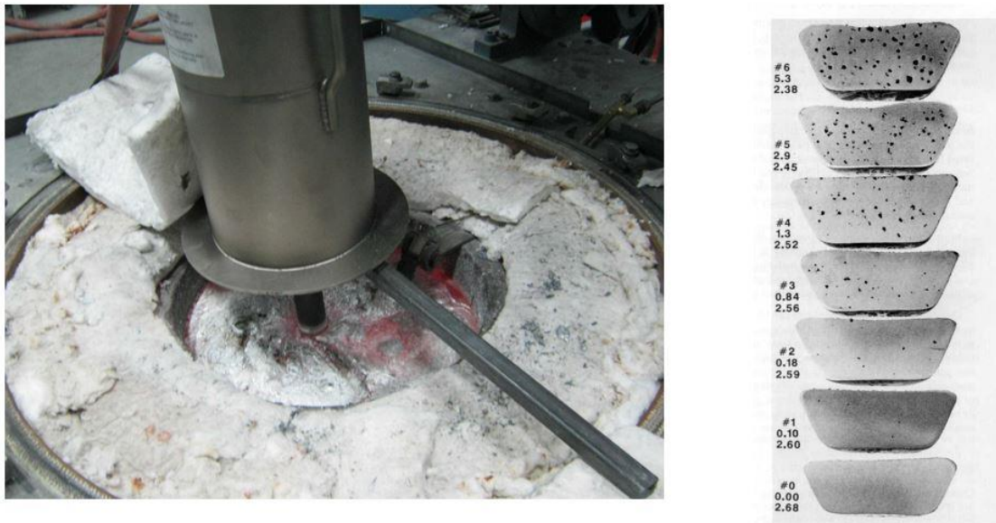
Figure 4. Dégazage au rotor et porosité évaluée par le test sous pression réduite.
