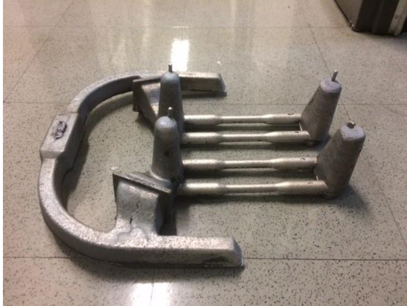
Figure 3. Canal d'alimentation avec filtres et masselotte latérales
