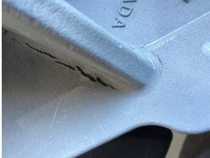
Figure 5. Fissuration à chaud du magnésium en moule permanent : les alliages d'aluminium 201 ou 535 sans silicium ont un comportement similaire.
