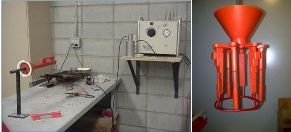
Figure 4. Montage en grappe (ici montage pour titane coulé en chute)
