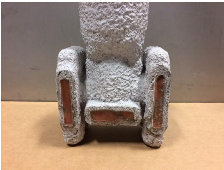
Figure 6. Coupe d'un moule avant le décirage
