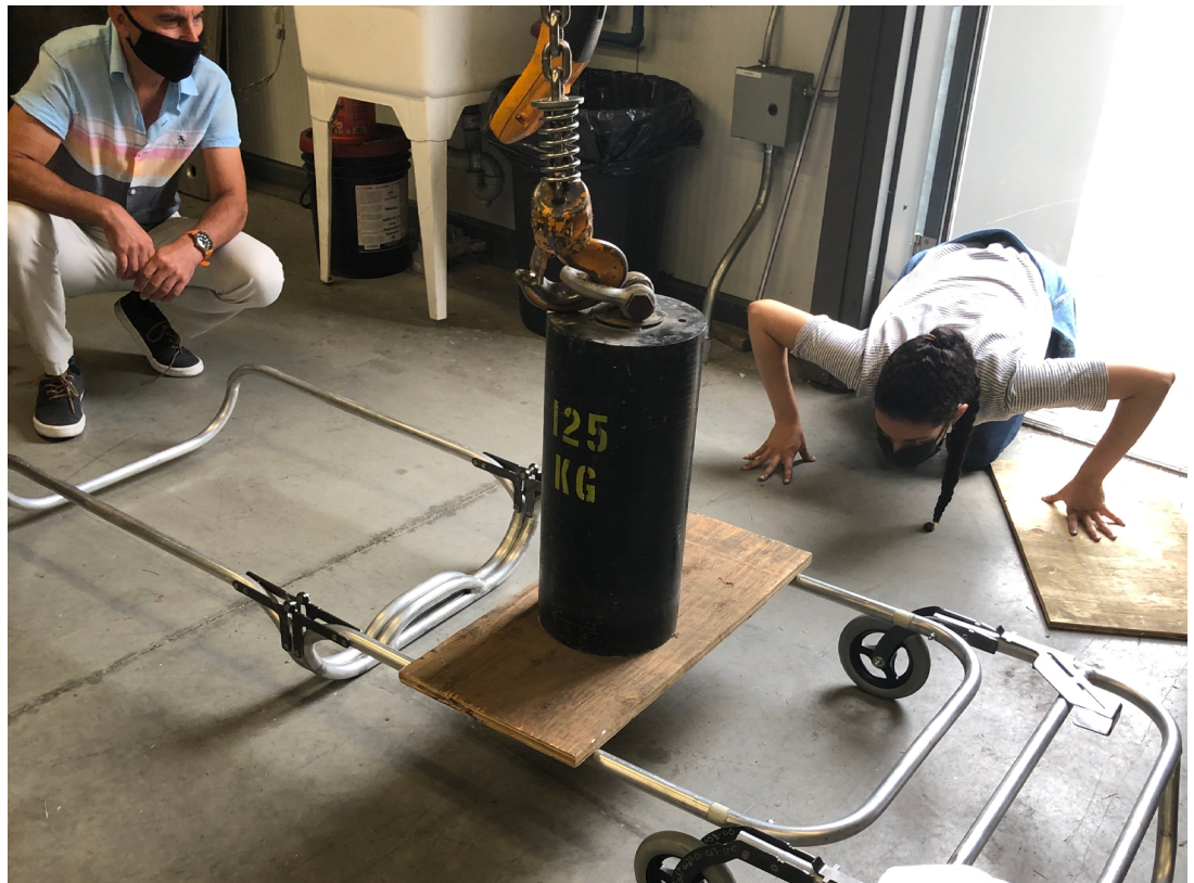
Pruebas de carga en laboratorio con 125 kg Blainville, QC, 2021
